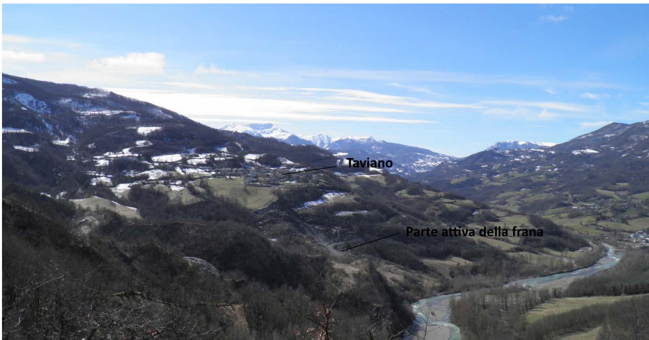
Fig. 7- La frana di Taviano. Si può notare l'abitato, che sorge su deposito di frana quiescente, e la parte basale più attiva della frana, in prossimità dell'alveo dell'Enza, oggetto di opere di stabilizzazione.
